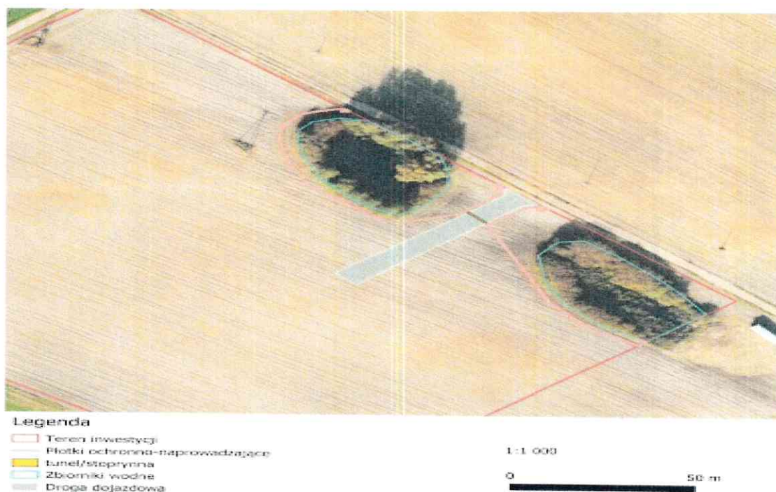
Ryc. 3. Trwałe wygradzenia herpetologiczne (czerwona linia) oraz przejście dla płazów w formie tzw. stoprynni
